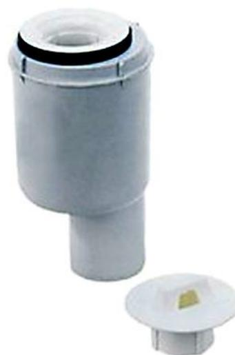
DALLMER Ablaufgehäuse TELOS V nach DIN EN 274. Für Duschwannen mit einem Ablaufloch von d=50 mm. Ablaufstutzen: DN 50 senkrecht Ablaufleistung: 0,72 l/s Material: Polypropylen, hochschlagfest
