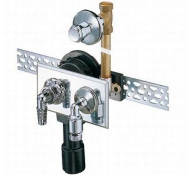
DALLMER Wandeinbau-Waschgeräte-Siphon 405, nach DIN 19541 für den direkten Wandeinbau. Mit integrierter Wasserversorgung für ein Waschgerät. Separates UP-Ventil 1/2" mit eingebautem Rückflussverhinderer. Komplett mit Siphon, Montageschiene, Schlauch-anschlussbogen mit Rohrbelüfter, MS-Wandscheibe. Abdeckplatte aus Edelstahl 190 x 110 mm Material Siphon: Polyethylen, schweißbar
