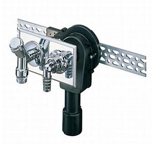
DALLMER Wandeinbau-Waschgeräte-Siphon 406, nach DIN 19541 für den direkten Wandeinbau. Mit kleinem strömungs- günstigen Gehäuse, montiert auf schalldämmender Montageplatte, Leifeld-Montageschiene, MS-Wandscheibe, Armaturenkombination mit Rückfluss- verhinderer u. Rohrbelüfter, Winkel- schlauchtülle verchromt, Abdeckplatte 190 x 110 mm aus Edelstahl Material Siphon:Polyethylen, schweißbar
