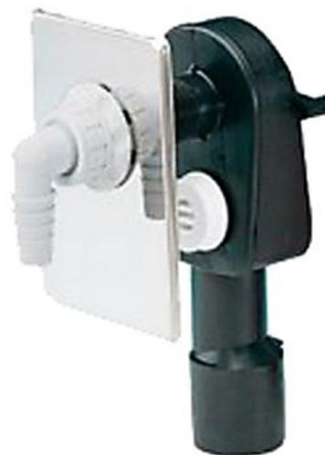
DALLMER Wandeinbau-Waschgeräte-Siphon HL400, DN 40/50 nach DIN 19541 für den direkten Wandeinbau, mit kleinem strömungsgünstigen Gehäuse, Reinigungsverschluss, langem absägbaren Schraubstutzen, Winkelschlauchtülle, Abdeckplatte aus Edelstahl 110 x 160 mm Einbautiefe 60 - 110mm
