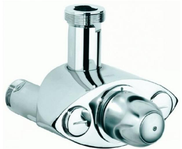
GROHE Grohtherm XL Thermostat-Batterie, DN 32 Wandmontage GROHE StarLight Chromoberflächen Einsatzbereich 9l/min bis 140l/min Dehnstoff-Thermoelement Temperaturwählgriff mit voreinstellbarem Sicherheitsendanschlag zwischen 33 Grad C und 43 Grad C Einrichtung zur Erleichterung der thermischen Desinfektion eingebaute Rückflussverhinderer und Schmutzfangsiebe als kompakte Service-Einheit Anschlussgewinde 1 1/2" Abgangsgewinde 2" Abgang oben/unten wechselbar ohne Anschlüsse
