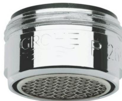
GROHE Laminar-Strahlregler, M 24 x 1 Aussengewinde, Durchflussklasse Z 9 l/min. bei 3,5 bar, GROHE StarLight Chromoberflächen
