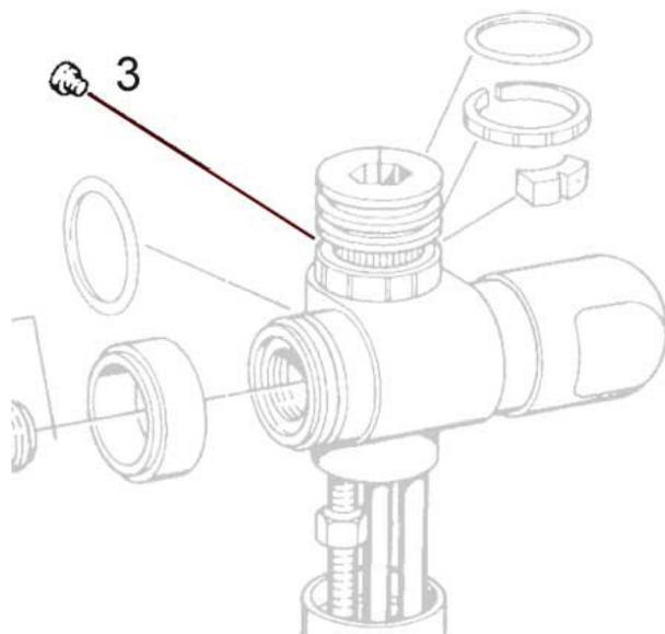
Bild Position 3: Hansa Auslaufbefestigungsschraube, M 4, mit Dichtung für Spültisch Einlochatterie Nr. 0078 2105
