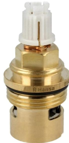
Hansa Oberteil DN20 G3/4 180° mit keramischen Dichtscheiben zur Wassermengeneinstellung für einen Abgang.
