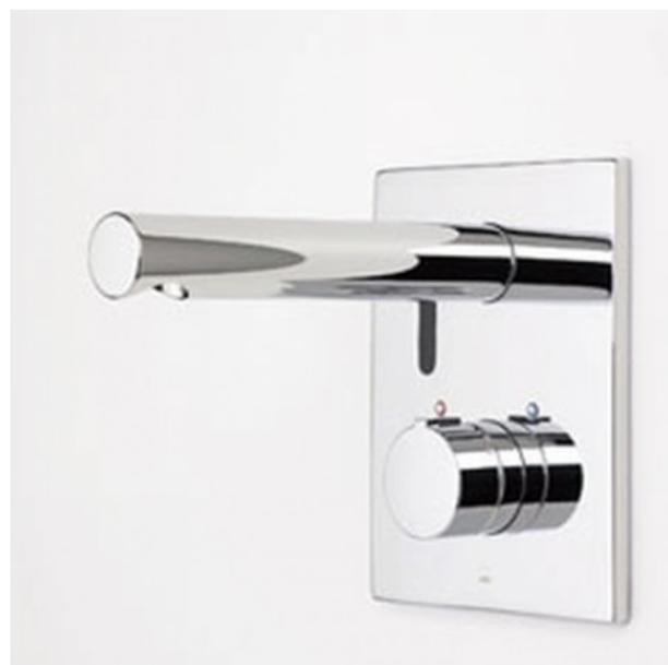
Oras Electra (6257C) Feinbauset UP-Waschtisch-Wand-Thermostatbatterie, berührungsfrei, 6V Batteriebetrieb, mit Sicherheitssperre bei 38°C.
