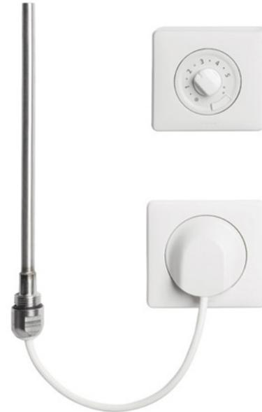
Elektroheizeinsatz WKS Unterputzlösung mit elektronischem Regler-Set: UP-Regler und UP-Wandauslass. Der Regler wird in eine Unterputzdose eingebaut und muss über ein Kabel mit dem UP-Wandauslass verbunden werden.
