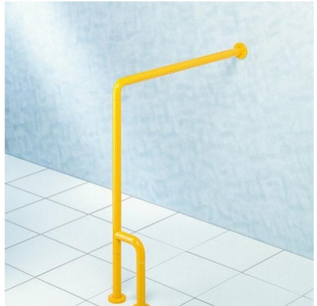
1000 x 320 mm, aus Nylon, Farbe Gelb (022), Durchmesser 34 mm, mit korrosionsgeschütztem durchgehendem Stahlkern, mit rutsicherer Griffzone durch strukturierte Oberfläche, mit Zwischenringen, links und rechts einsetzbar, mit Rosetten Durchmesser 70 mm für verdeckte Verschraubung, Rosettenunterteile und Schrauben aus Edelstahl. Lieferung mit Edelstahlschrauben Durchmesser 6 x 60 mm und Dübel für Vollbaustoffe. Nachrüstbar mit Papierrollenhalter NY.PRH 95-N oder NY.PRH 96-N mit Diebstahlschutz.
