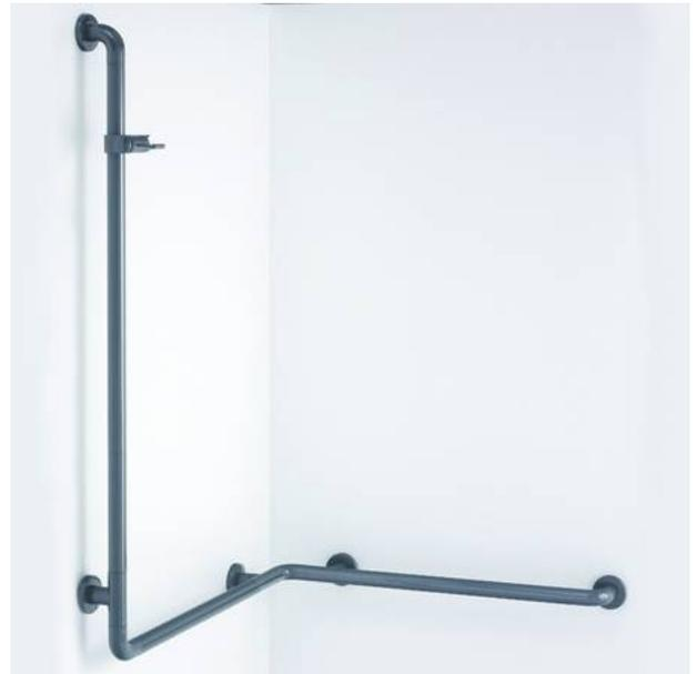
aus Nylon, Farbe Manhattan (067), Durchmesser 34 mm, mit korrosionsgeschütztem durchgehendem Stahlkern, mit rutsicherer Griffzone durch strukturierte Oberfläche, mit Zwischenringen, mit stufenlos verstellbarem Brausehalter NY.BRH 91, links und rechts einsetzbar, mit stahlverstärkten Rosetten Durchmesser 70mm für verdeckte Verschraubung, Rosettenunterteile und Schrauben aus Edelstahl. Lieferung mit Edelstahlschrauben Durchmesser 6 x 60 mm und Dübel für Vollbaustoffe.
