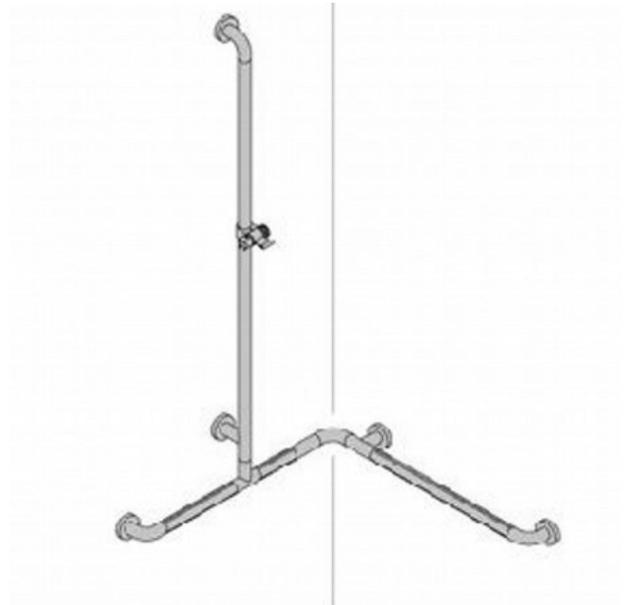
aus Nylon, Farbe Weiss (019), Durchmesser 34 mm, mit korrosionsgeschütztem durchgehendem Stahlkern, mit rutschsicherer Griffzone durch strukturierte Oberfläche, mit Zwischenringen, mit stufenlos verstellbarem Brausehalter NY.BRH 91, links und rechts einsetzbar, mit stahlverstärkten Rosetten Durchmesser 70mm für verdeckte Verschraubung, Rosettenunterteile und Schrauben aus Edelstahl. Lieferung mit Edelstahlschrauben Durchmesser 6 x 60 mm und Dübel für Vollbaustoffe.
