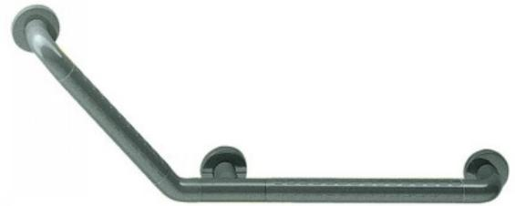
501 x 312 mm, 135°, aus Nylon, Farbe Manhattan (067), Durchmesser 34 mm, mit korrosionsgeschütztem durchgehendem Stahlkern, mit rutschsicherer Griffzone durch strukturierte Oberfläche, mit Zwischenringen, links und rechts einsetzbar, mit stahlverstärkten Rosetten Durchmesser 70 mm für verdeckte Verschraubung, Rosettenunterteile und Schrauben aus Edelstahl. Lieferung mit Edelstahlschrauben Durchmesser 6 x 60 mm und Dübel für Vollbaustoffe.
