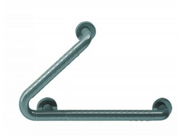
510 x 321 mm, 45°, aus Nylon, Farbe Manhattan (067), Durchmesser 34 mm, mit korrosionsgeschütztem durchgehendem Stahlkern, mit rutschsicherer Griffzone durch strukturierte Oberfläche, mit Zwischenringen, links und rechts einsetzbar, mit stahlverstärkten Rosetten Durchmesser 70 mm für verdeckte Verschraubung, Rosettenunterteile und Schrauben aus Edelstahl. Lieferung mit Edelstahlschrauben Durchmesser 6 x 60 mm und Dübel für Vollbaustoffe.
