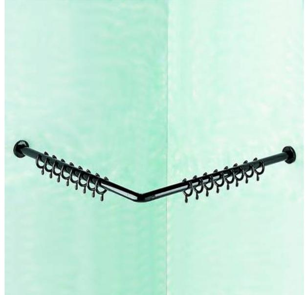
Angaben a1 ... mm, a2 ... mm, aus Nylon, Farbe Manhattan (067), Durchmesser 34 mm, ausgesteift mit korrosionsgeschütztem Stahlkern, auf jedes Mass kürzbar, mit Rosetten Durchmesser 70 mm für verdeckte Verschraubung, mit Anschlussbohrung für Deckenabhängung, incl. Vorhangringe. Lieferung mit Schrauben und Dübel. Auf Anfrage in anderen Längen und ohne Anschlussbohrung für Deckenabhängung lieferbar.
