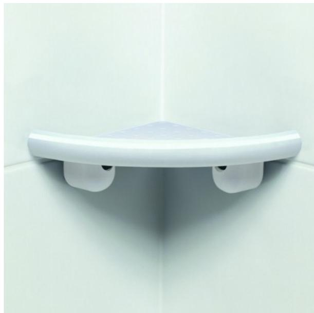
170 x 170 x 63 mm, aus Nylon, Farbe Weiss(019), Ablagefläche 200 cm<sup>2</sup>, Ablageschale zur Reinigung ohne Werkzeugabnehmbar, mit rückseitigem Wasserablauf und zusätzlichem Ablaufloch, zur Montage sind nur zwei Befestigungsbohrungen erforderlich. Lieferung mit Schrauben und Dübel.
