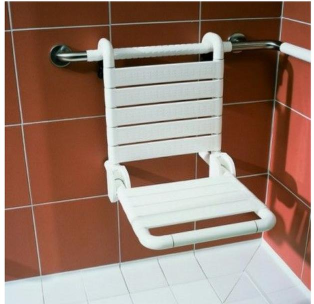
380 x 564 x 459 mm, aus Nylon, Farbe Manhattan (067), Durchmesser 34 mm, mit korrosionsgeschütztem durchgehendem Stahlkern, Sitzleisten und Rückenlehne aus Nylon, mit Zwischenringen, stahlverstärkte Scharniere mit einstellbarer Bremse, mit Arretiervorrichtung, zum Einhängen in NORMBAU Duschhandläufe und Haltegriffe, in hochgeklapptem Zustand automatisch arretiert mit einer Ausladung von 234 mm, mit Abdeckkappen.
