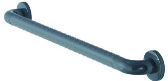
Achsmass 1000 mm, aus Nylon, Farbe Manhattan (067), Durchmesser 34 mm, mit korrosionsgeschütztem durchgehendem Stahlkern, mit rutschsicherer Griffzone durch strukturierte Oberfläche, mit Zwischenringen, mit Rosetten Durchmesser 70 mm für verdeckte Verschraubung, Rosettenunterteile und Schrauben aus Edelstahl. Lieferung mit Edelstahlschrauben Durchmesser 6 x 60 mm und Dübel für Vollbaustoffe.
