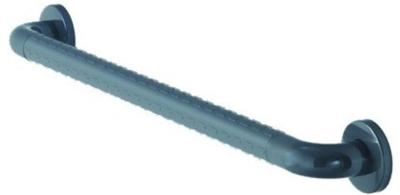
Achsmass 800 mm, aus Nylon, Farbe Manhattan (067), Durchmesser 34 mm, mit korrosionsgeschütztem durchgehendem Stahlkern, mit rutschsicherer Griffzone durch strukturierte Oberfläche, mit Zwischenringen, mit Rosetten Durchmesser 70 mm für verdeckte Verschraubung, Rosettenunterteile und Schrauben aus Edelstahl. Lieferung mit Edelstahlschrauben Durchmesser 6 x 60 mm und Dübel für Vollbaustoffe.
