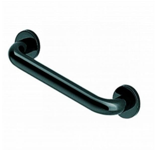
mit stahlscheibenverstärkten Rosetten Achsmass 300 mm, aus Nylon, Farbe Manhattan (067), Durchmesser 34 mm, mit korrosionsgeschütztem durchgehendem Stahlkern, ohne oder mit Rosetten Durchmesser 70 mm, verdeckte Verschraubung, Rosettenunterteile und Schrauben aus Edelstahl. Lieferung mit Edelstahlschrauben Durchmesser 6 x 60 mm und Dübel für Vollbaustoffe.
