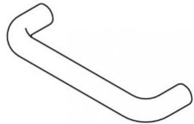
ohne Rosetten Achsmass 300 mm, aus Nylon, Farbe Manhattan (067), Durchmesser 34 mm, mit korrosionsgeschütztem durchgehendem Stahlkern, ohne oder mit Rosetten Durchmesser 70 mm, verdeckte Verschraubung, Rosettenunterteile und Schrauben aus Edelstahl. Lieferung mit Edelstahlschrauben Durchmesser 6 x 60 mm und Dübel für Vollbaustoffe.
