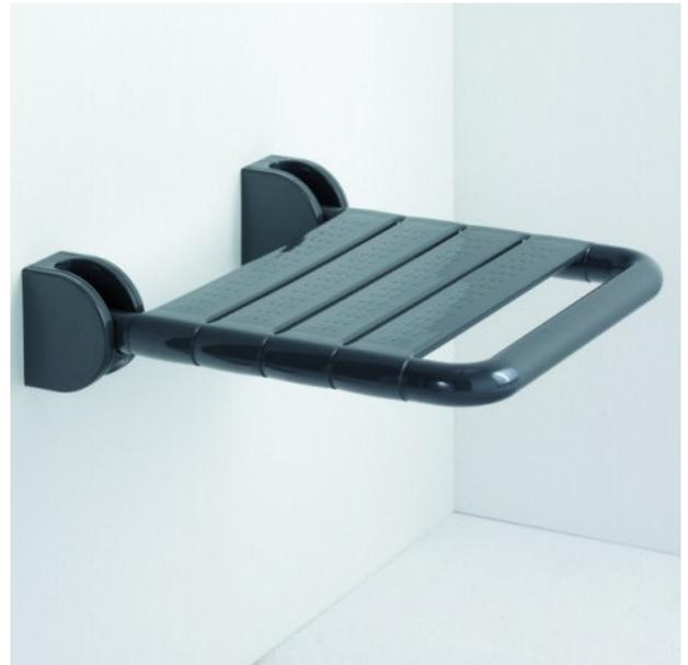
380 x 410 mm, aus Nylon, Farbe Manhattan(067), Durchmesser 34 mm, mit korrosionsgeschütztem durchgehendem Stahlkern, Sitzleisten aus Nylon, mit Zwischenringen, stahlverstärkte Scharniere mit einstellbarer Bremse, in hochgeklapptem Zustand automatisch arretiert mit einer Ausladung von 80 mm, mit Abdeckkappen für verdeckte Verschraubung.
