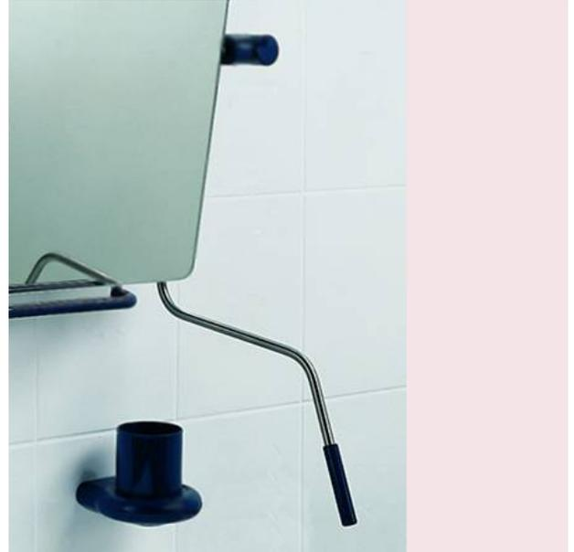
aus Edelstahl (A4) Werkstoff Nr. 1.4401 (AISI 316), Oberfläche fein matt, Durchmesser 10 mm, Griff aus Nylon Durchmesser 15 mm, Farbe Grün (013), nachrüstbar für Kippspiegel der Serie NY.466, seitlich schwenkbar mit einstellbarer Klemmkraft, links und rechts montierbar, bei Waschbecken mit Vorwandmontage bis 150 mm Tiefe. Sonderanfertigungen auf Anfrage möglich.
