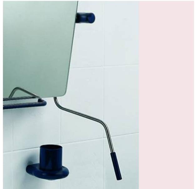
aus Edelstahl (A4) Werkstoff Nr. 1.4401 (AISI 316), Oberfläche fein matt, Durchmesser 10 mm, Griff aus Nylon Durchmesser 15 mm, Farbe Schwarz (016), nachrüstbar für Kippspiegel der Serie NY.466, seitlich schwenkbar mit einstellbarer Klemmkraft, links und rechts montierbar, bei Waschbecken mit Vorwandmontage bis 150 mm Tiefe. Sonderanfertigungen auf Anfrage möglich.
