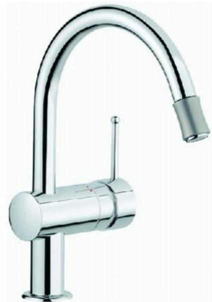
GROHE Minta Einhand-Spültischbatterie, DN 15 Einlochmontage GROHE SilkMove 46 mm Keramikkartusche GROHE StarLight Chromoberflächen variabel einstellbare Mengenbegrenzung schwenkbarer Rohauslauf integrierter, herausziehbarer Mousseurauslauf Rückholhilfe integrierte Rückflussverhinderer flexible Anschlusschläuche Schnell-Montage-System Eigensicher gegen Rückfließen.
