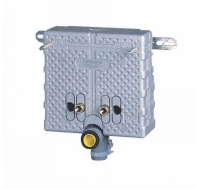
GROHE Uniset für Waschtisch für Einlochbatterie schalldämmendes EPS-Modul zum Ummauern, mit geschlossener Oberfläche Schienenadapter für Modulbefestigung für Einzel- oder Reihenmontage Befestigungszubehör für Einzelmontage höhenverstellbarer Armaturen- und Ablaufanschluss Waschtisch-Haltebolzen Schraubenabstand 280 mm HT-Ablaufbogen DN 50 Dichtung D: 32 mm 2 Armaturenanschlüsse DN 15 Befestigungsmaterial für Waschtisch ohne Standkonsolen
