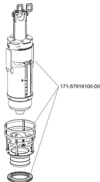
JOMO-WERIT SLK plus Ablaufventil 2.0 inkl. Bodenventil, Spritzschutzplatte und Abschluss-Scheibe
