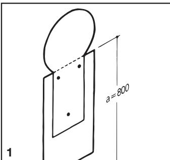
**D** Bohrschablone ausrichten. Montagehöhe von Oberkante Fertigfußboden  $a = 800$  mm. Achtung: Schwenkbereich des Deckels beachten. Dübellöcher 8 mm ø bohren.
