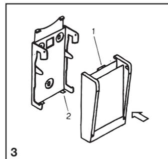
**D** Ablage aufschieben und mit leichtem Schlag andrücken, bis beide Federbolzen hörbar einrasten.
