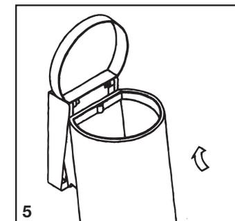
**D** Behälter schräg von unten in Abdeckung schieben und einhängen.
