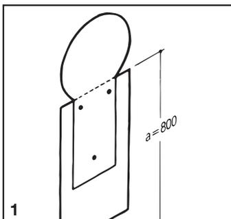
**D** Anreißschablone an Mittellinie ausrichten. Bohrpunkte anzeichnen.
