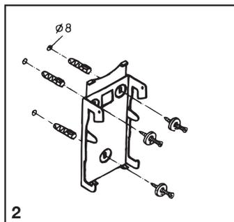
**D** Dübellöcher 8 mm  $\varnothing$  bohren. Sockel so aufschrauben, daß beide Federbolzen (1) nach innen zeigen.
