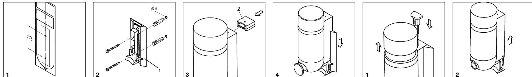
**D** Anreißschablone an Mittellinie ausrichten. Bohrpunkte anzeichnen. Achtung: Abmaße des Seifenspender beachten.
