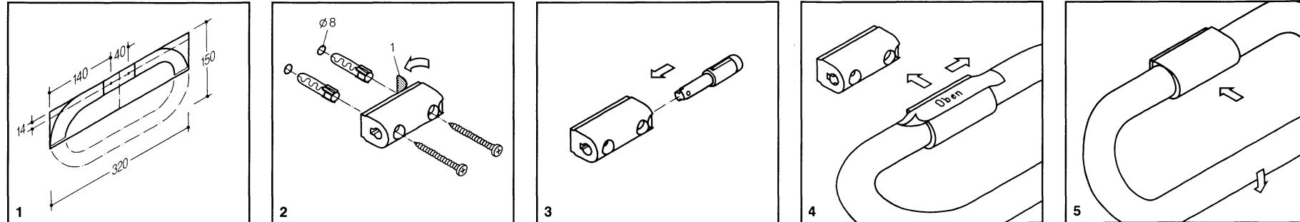
**D** Anreißschablone an Mittellinie ausrichten. Bohrpunkt anzeichnen.
